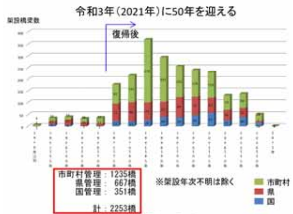
図-1 建設年別の橋梁数(沖縄県)
