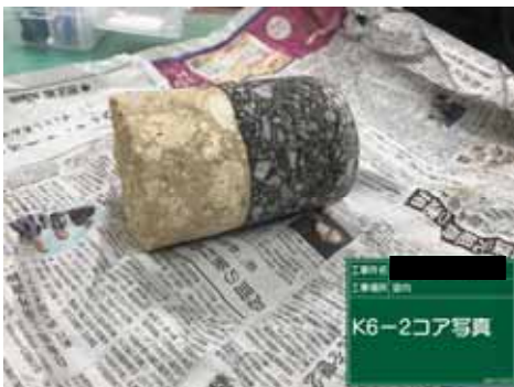
写真-7 基層が健全なコア
