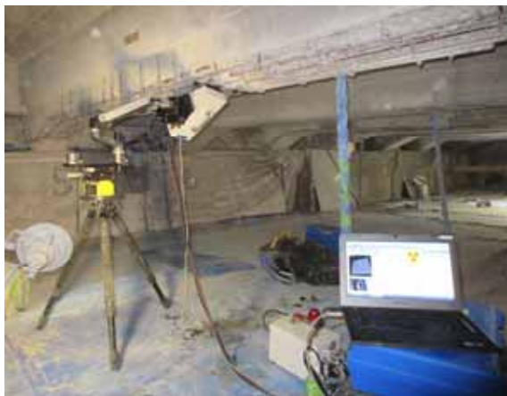
図-10 応力測定状況
