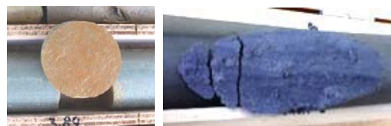
写真-3 すべり面亀裂状況
