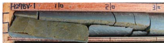
写真-2 すべり面亀裂状況
