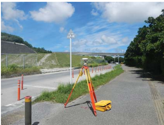
写真-1 スタティック法による点検測量 表-1 スタティック法による点検値
