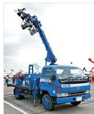
写真-6 移動式照明設備 (クレーン式)
