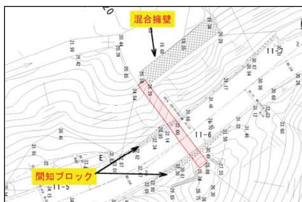
図-3. カルバート周辺の構造物
