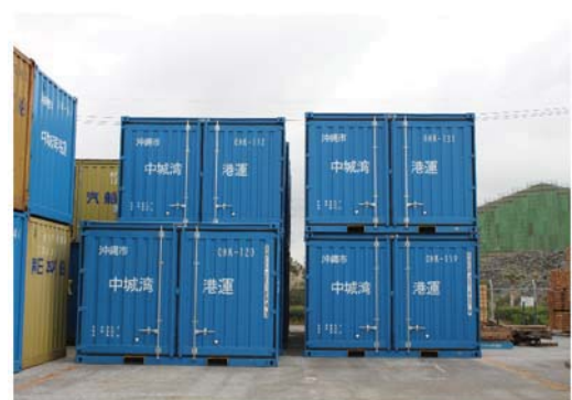
写真-5 12ft コンテナ (L 3,658×W2,438×H2,591)
