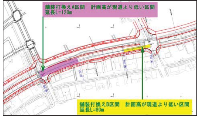
図-6 舗装打換え箇所の概要
