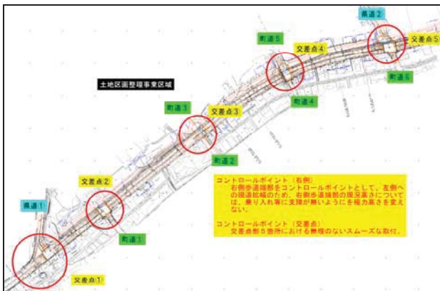
図-4 縦断計画のコントロールポイント
