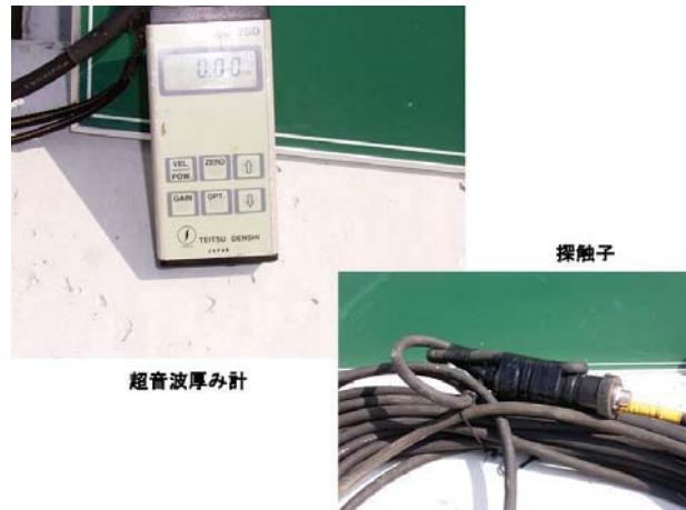
写真-1. 超音波厚み計と探触子
