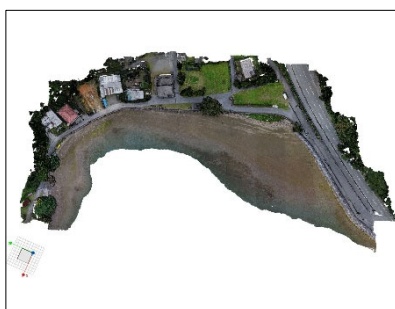
3次元点群データ（ドローン） 塩屋港海岸（白浜地区）測量設計業 務委託（R4） （北部土木事務所）
