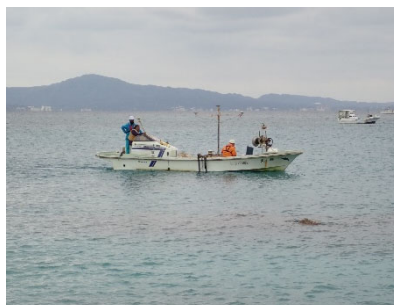
マルチビーム深浅測量 国道449号災害防除測量設計 業務委託（R4） (北部土木事務所)
