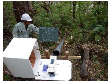
伸縮計設置状況 津覇急傾斜地調査測量設計業務 (中部土木事務所)
