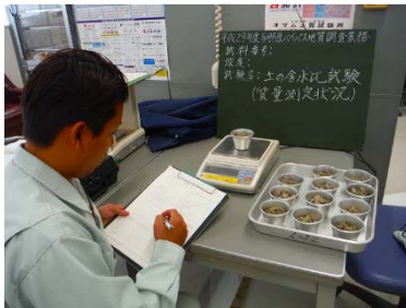
土質試験室 (土の含水比試験状況)
